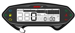
• Dans l'écran d'horloge, appuyez sur le bouton **Sélection** une fois pour passer à l'écran de tension.
