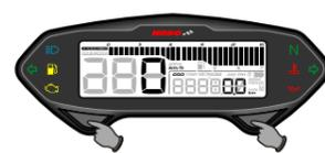
• Ecran de kilométrage total - Appuyez et maintenez les boutons **Sélection + Réglage enfoncés pendant 3 secondes** pour entrer dans l'écran de réglage.
