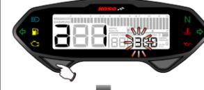
• Appuyez sur le bouton **Sélection** pour accéder au réglage du point de détection.
