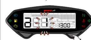
• Appuyez sur le bouton **Réglage** pour entrer dans le réglage de fonctionnement suivant.
